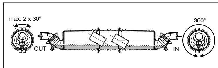
Ai fini di un buon funzionamento è necessario che la parte OUT (USCITA) e le due parti centrali del corpo si trovino nella posizione indicata nel disegno. Una rotazione di 30° in entrambe le direzioni è ammessa.
