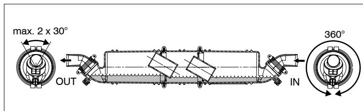
Für ein ordnungsgemäßes Funktionieren ist es erforderlich, dass sich das OUT-Gehäuseteil und die beiden Innenteile in der gezeichneten Position befinden. Eine Verdrehung von maximal 30° nach jeder Seite ist erlaubt.
