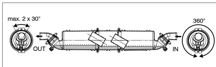
Para un funcionamiento correcto es necesario que la parte de salida (OUT) de la carcasa y las dos partes internas se encuentren en la posición indicada en la imagen. Está permitida una desviación máxima de 30° hacia cada lado.
