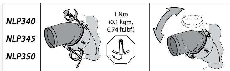
**¡Soltar las tornillos antes de girar las conexiones de manguera!** Volver a apretar las conexiones de manguera observando un punto de 1 Nm.
