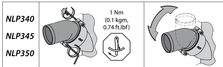
Draai de bouten los alvorens de slangaansluitingen te verdraaien! Schroef de slangaansluitingen weer vast met een aanhaalmoment van 1 Nm.
