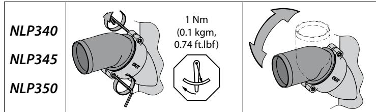
**Desserrer les boulons avant de tourner les raccordements de tuyau!**
