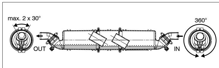
**Pour le bon fonctionnement du système, il est essentiel que la partie OUT (sortie) ainsi que les deux pièces intérieure soient dans la position illustrée. Une rotation de 30° maximum de chaque côté est tolérée.**
