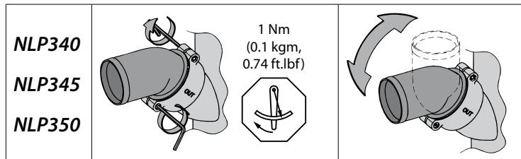
**Lösen Sie die Bolzen, bevor Sie die Schlauchverbindungen drehen!** Schrauben Sie die Schlauchverbindungen mit einem Anzugsmoment von **1 Nm** wieder fest.
