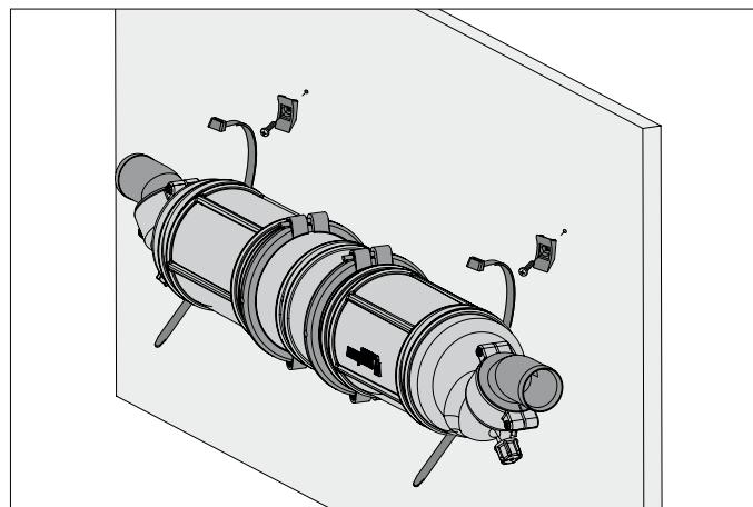
Le waterlock est doté d'encoches dans lesquelles doivent être encastres les Ty-raps®.
