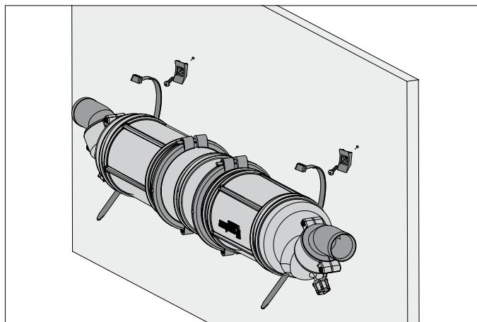
Der Wassersammler ist mit Schlitten versehen, in welche die Ty-raps® eingesetzt werden.
