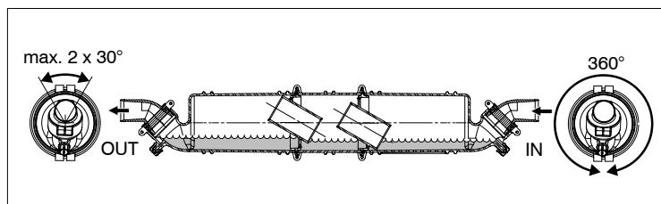
Voor een goede werking is het noodzakelijk dat het OUT (UIT) huisdeel en de beide binnendelen in de getekende stand staan. Een verdraaiing van maximaal 30° naar elke kant is toegestaan.
