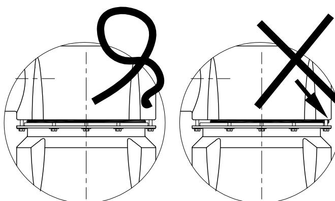
Serrer les boulons M6 de façon égale. Veillez à ce que la partie supérieure ne soit pas de travers !
