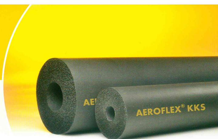
Der hochflexible, geschlossenzellige Dämmstoff auf EPDM-Basis besticht durch seine hervorragenden Materialeigenschaften wie hohe Witterungs-, UV- und Ozonbeständigkeit, eine ausgezeichnete Temperaturbeständigkeit, sowie einen besonders niedrigen Wärmeverlustwert ( $\lambda_{40} = 0,040 \text{ W/mK}$ ).
