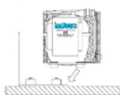
Instalación en mamparo horizontal
