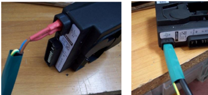
Рисунок 11: Деталь соединения с двойной изоляцией
