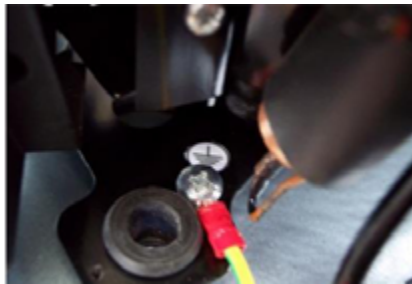
Figure 12 : Connexion particulière câble de terre sur la partie métallique du compresseur
