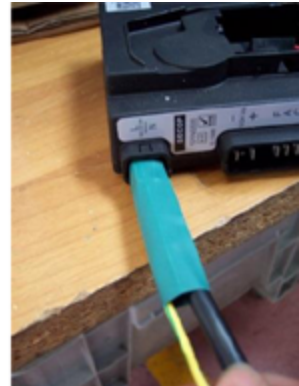
Abbildung 11: Detailansicht doppelt isolierter Anschluss
