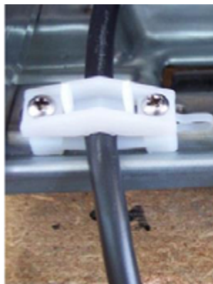
Рисунок 13: Деталь двойного крепления кабель
