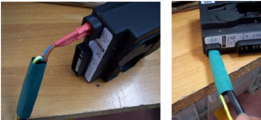
Figur 11: Detalj av anslutning med dubbel isolering
