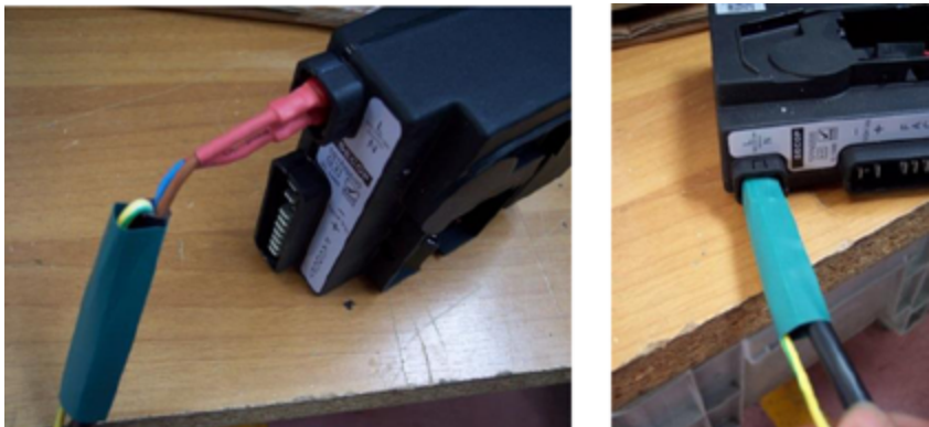
Figura 11: Detalle de conexión con doble aislamiento
