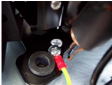
Kuva 12: Maadoitusjohto kompressorin metalliosassa
