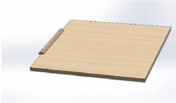
Kuva 7: Tuotteen mukana toimitettu puukappale haihduttimien taittamiseen
