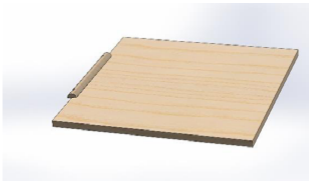
Figure 7 : Accessoire en bois fourni pour plier les évaporateurs
