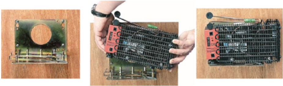
Figura 5: Detalle de la fijación grupo compresor - soporte
