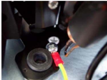
Рисунок 12: Деталь соединения кабеля заземления на металлической части компрессора - после установки кабель фиксируется с помощью системы двойного крепежа, как показано на рисунке.
