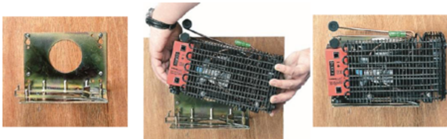
Рисунок 5: Деталь крепления компрессорного блока - кронштейна
