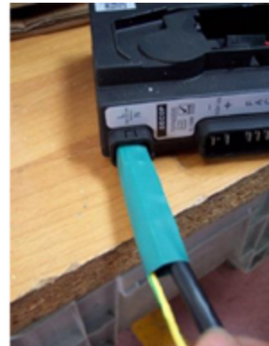
Afbeelding 11: Detail aansluiting met dubbele isolatie
