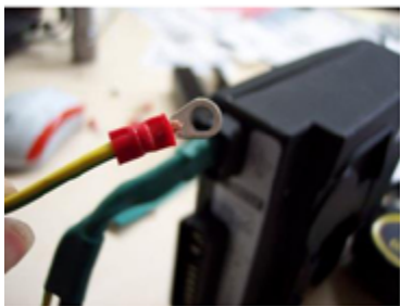
Abbildung 12: Detailansicht Erdungskabelanschluss am Metallgehäuse des Kompressors
