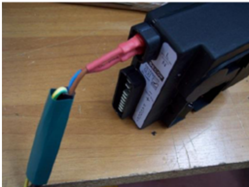
Figure 11 : Connexion particulière à double isolation
