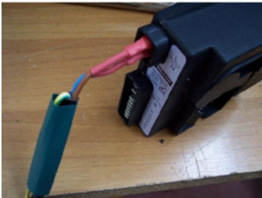
Abbildung 11: Detailansicht doppelt isolierter Anschluss
