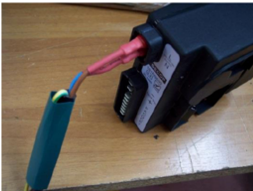
Afbeelding 11: Detail aansluiting met dubbele isolatie
