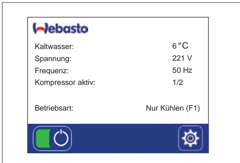
Abb. 5 Beispiel Startbildschirm Chiller-Einheit ohne Kabinensteuerung
