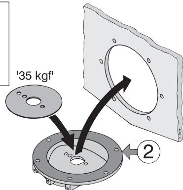
Monter la bride à l'aide des boulons, écrous et rondelles de blocage fournis.
