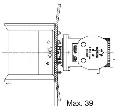
Bietet der Spiegel für den Einbau der Heckschraube nicht die ausreichende Höhe, kann zur Montage der Schraube gegebenenfalls eine Schräge geschaffen werden. Bedenken Sie, daß das Tunnelrohr dann jedoch gegen die während der normalen Fahrt einwirkende Kraft des Wassers geschützt werden muß. Das Tunnelrohr sollte nach Möglichkeit nicht über die Fläche hinausragen.
