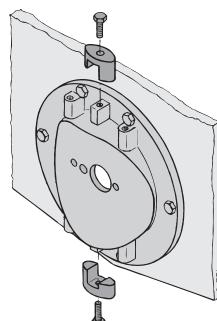
Montare il tunnel sulla flangia con i dadi e le rondelle.
