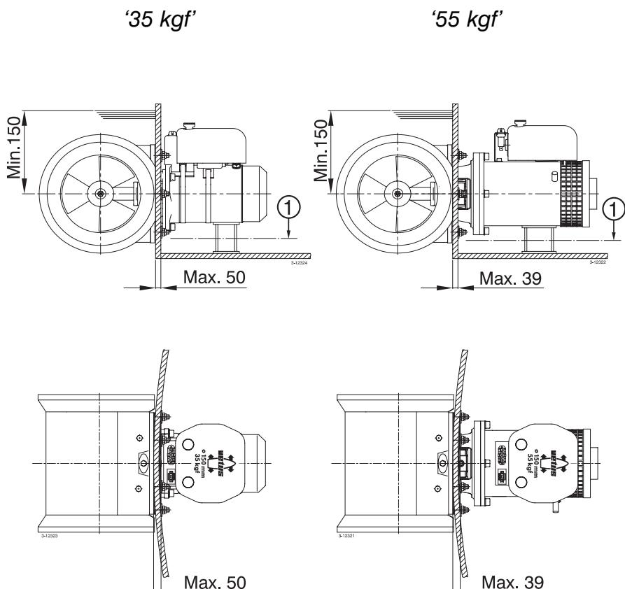
Indien de spiegel onvoldoende hoogte biedt voor de montage van de hekschroef kan eventueel een schuin vlak worden gemaakt om de hekschroef te monteren. Denk er aan dat de tunnelbuis dan wel beschermd moet worden tegen de optredende kracht van het water tijdens de normale vaart. Laat de tunnelbuis bij voorkeur niet onder het vlak uisteken.
