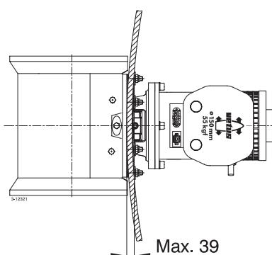
Se lo specchio di poppa non offre un'altezza sufficiente per il montaggio dell'elica, si può eventualmente applicare un piano inclinato. Ricordare, in questo caso, di proteggere il tunnel dalla forza dell'acqua durante la navigazione normale. È preferibile non lasciare che il tunnel fuoriesca al di sotto della carena.
