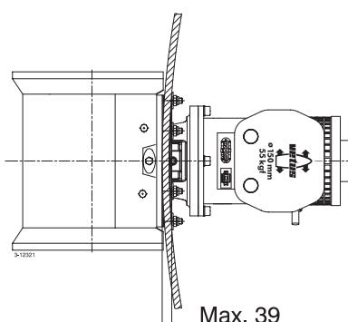
Si el espejo no ofrece la altura suficiente para el montaje de la hélice de popa, se puede elaborar eventualmente una superficie oblicua para montar la hélice de popa. Tómese en cuenta que en este caso es necesario proteger el conducto contra la fuerza producida por el agua durante una navegación normal. Es conveniente no dejar salir por debajo del plano el conducto.
