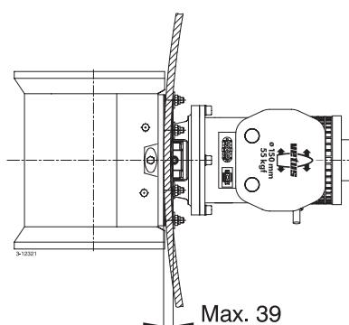
Si l'arcasse présente une hauteur insuffisante pour le montage de l'hélice de poupe, on peut éventuellement créer une surface inclinée pour monter l'hélice de poupe. Pensez que le tunnel tubulaire devra être protégé contre la force de l'eau qui est générée pendant la navigation normale. Evitez de faire dépasser le tunnel tubulaire sous la surface.
