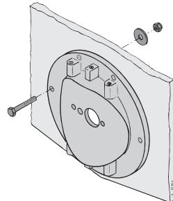
Bringen Sie die beiden zum Lieferumfang gehörenden Zinkanoden an.
