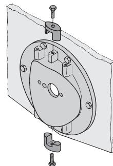
Monter le tunnel sur la bride à l'aide des boulons et rondelles de blocage fournis.
