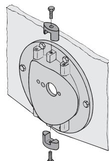
Montar el conducto en la brida con los tornillos y arandelas planas suministrados.
