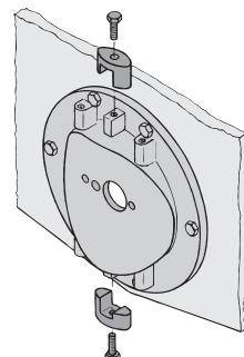
Schließen Sie mit Hilfe der zum Lieferumfang gehörenden Schrauben und Unterlegscheiben den Tunnel an den Flansch an. **Versehen Sie diese M6x40-Schrauben mit einer Schraubensicherung.**
