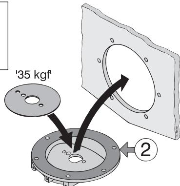
Der Flansch wird mittels der zum Lieferumfang gehörenden Schrauben, Muttern und Unterlegscheiben befestigt.
