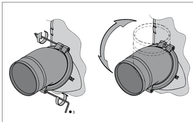
Beide Schlauchverbindungen sind um 360° drehbar, um die Schläuche optimal an den Wassersammler anschließen zu können.
