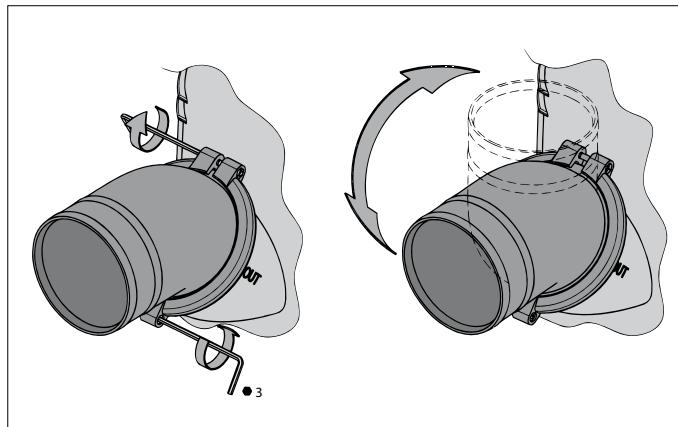
Pour assurer un raccord parfait des tuyaux sur le waterlock, les **deux** raccordements de tuyau peuvent tourner de 360°.
