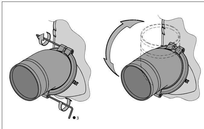
Om de slangen optimaal op de waterlock te kunnen aansluiten zijn beide slangaansluitingen  $360^\circ$  draaibaar.
