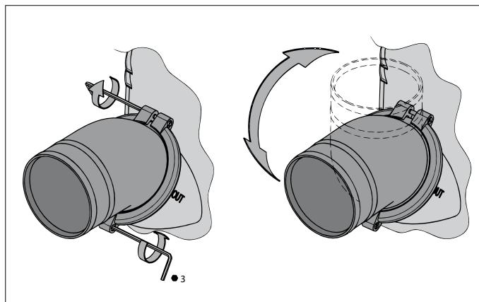
Con la finalidad de poder conectar de forma óptima las mangueras en el colector, **ambas** conexiones de manguera se pueden girar 360°.
