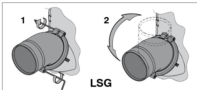
Para facilitar el montaje de la manguera en las conexiones de manguera, utilizar exclusivamente agua y/o jabón, y no productos que contienen grasa o aceite.
