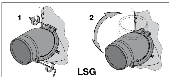
Gebruik uitsluitend water en/of zeep, dus geen vet- of oliehoudende producten, om het monteren van de slang op de slangaansluitingen te vereenvoudigen.
