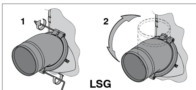
Utilizzare unicamente acqua e/o sapone, niente prodotti contenenti grasso o olio, per facilitare il montaggio del tubo di gomma sui raccordi.
