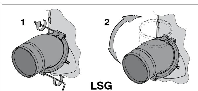
Utiliser uniquement de l'eau et/ou du savon, et non pas des produits gras ou huileux, pour faciliter le montage du tuyau sur les raccordements.
