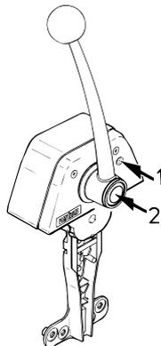
Wanneer de handel weer in de neutraalstand wordt gezet, zal de drukknop terugspringen en is de afstandsbediening gereed voor normaal gebruik.
