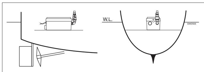
Se garantiza el buen funcionamiento del GWDS hasta un ángulo máximo de 10° en sentido longitudinal y 20° en sentido transversal de la embarcación.
