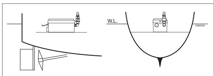
Die ordnungsgemäße Funktionsweise des GWDS ist bei einem maximalen Winkel von 10° längsschiffs und 20° querschiffs gewährleistet.
