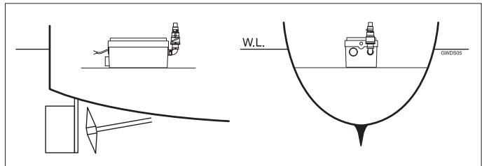
Een juiste werking van de GWDS is gegarandeerd tot een maximale hoek van 10° langsscheeps en 20° dwarsscheeps.
