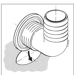
Bringen Sie den Ring und die Mutter an. Drehen Sie die Mutter mit dem Schlüssel und nicht mit einer Rohrzange fest. Ziehen Sie die Mutter nicht zu fest an.
