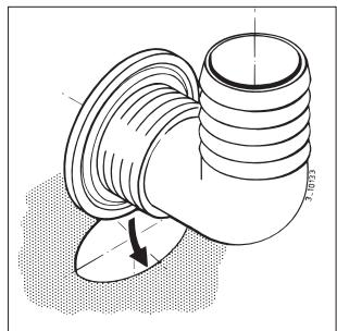
Breng de ring en de moer aan. Zet de moer vast met de sleutel, nooit met een waterpomptang. Draai de moer niet te vast aan.
