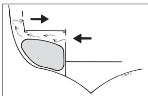
Die Abmessungen des Raumes müssen der Größe des Tanks entsprechen. In gefülltem Zustand muß der Tank seitlich ausreichend gestützt werden, und oben muß genügend Platz für die Schlauchanschlüsse und Schläuche sein.
