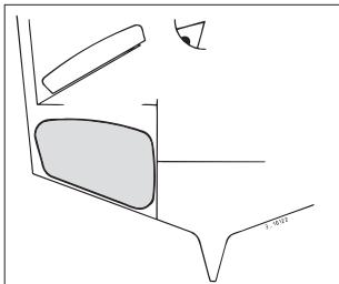
Il serbatoio va sempre montato al di sopra del livello massimo dell'acqua di sentina.
