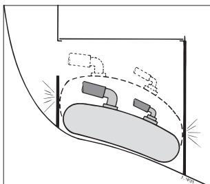
Der Boden und die Wände müssen glatt sein. Andernfalls kleiden Sie den Boden und die Wände mit Schaumstoff oder Filz aus.
