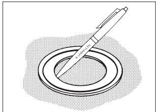
Schneiden Sie mit einer Schere das Loch in die Tankwand. **Schneiden Sie nicht aus Versehen in die gegenüberliegende Tankwand!**
