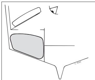
Der Tank muß immer über dem höchstmöglichen Niveau des Bilgewassers angebracht werden.
